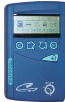
Réalisation d'un lecteur carte à puce avec transmission RF
