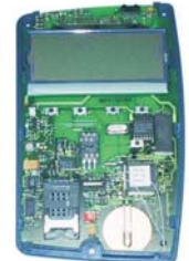
Réalisation d'un lecteur carte à puce avec transmission RF
